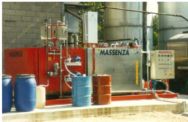
Planta de emulsión de betún tipo 4.000x2 AB SK
